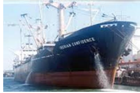
Figura 33: Navio em operação de deslastro
