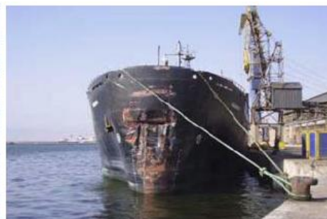
Figura 23: Incidente por colisão no canal do porto envolvendo uma draga: Navio Umfolozi, Namíbia
